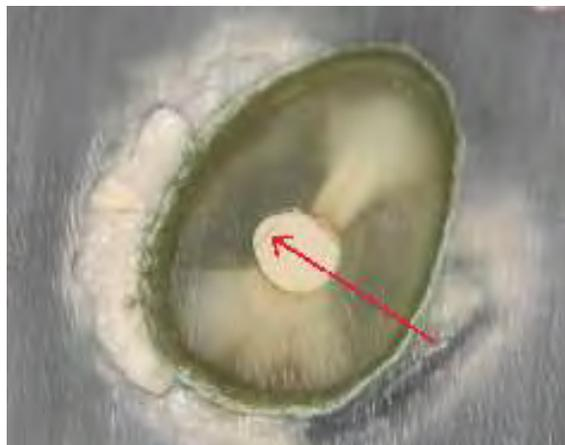
*Fig 32: exemple de trait de fracture sur l'échantillon 5B*
