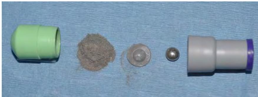
*Fig 9 : Contenu d'une capsule : particules métalliques à gauche séparées, via une membrane, du mercure liquide. (32)*
