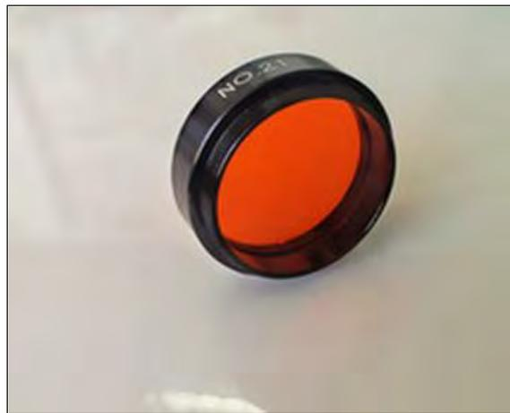
Figure 13: Filtre orange de microscope opératoire
