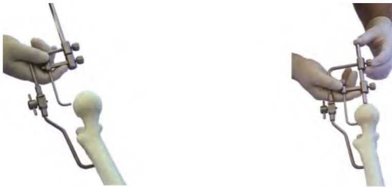
Figure 10 Positionnement de l'ancillaire de visée(1)
