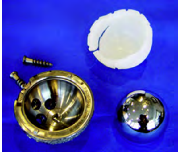
Figure 100 Fracture d'un PE hautement réticulé(1)
