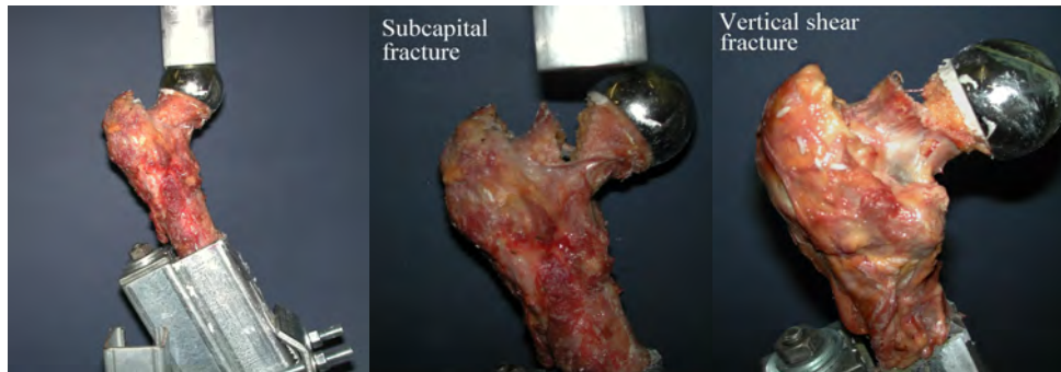
Figure 1 Modèle expérimental de presse(13). Type de fracture en fonction de l'orientation de l'implant fémoral(13) : fracture sous capitale si l'implant est en valgus et trait de fracture vertical si l'implant est en varus.
