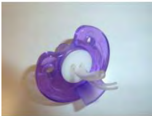
Figure 36 : Succiomètre réalisé par Luc Marlier et Thierry Pébayle du CNRS de Strasbourg (68)
