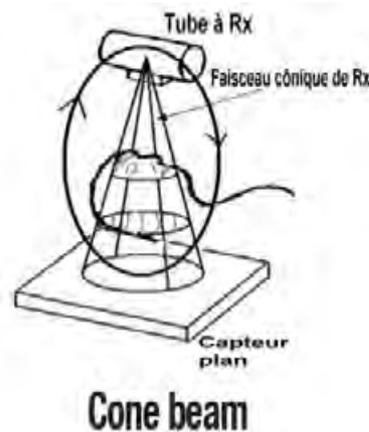
Figure 1: Principes de la tomographie à faisceau conique (65)
