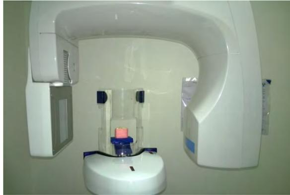
Figure 11 : Simulateur positionné au centre du champ de vue du Planmeca Promax 3Ds
