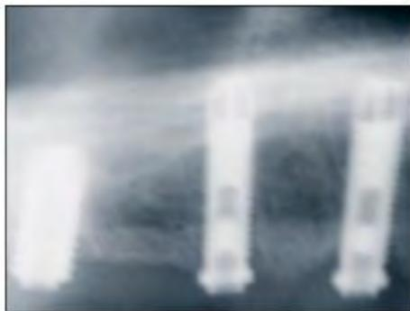
**Figure 26 - Radiographie de fractures de vis de piliers. Les fragments sont restés dans le pas de vis interne de l'implant.**
