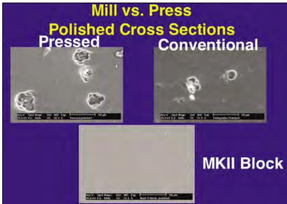
**Figure 36** : Image en ME d'une céramique pressée, conventionnelle (montée manuellement) et d'un bloc Vita Mark II (Vita®).(52)
