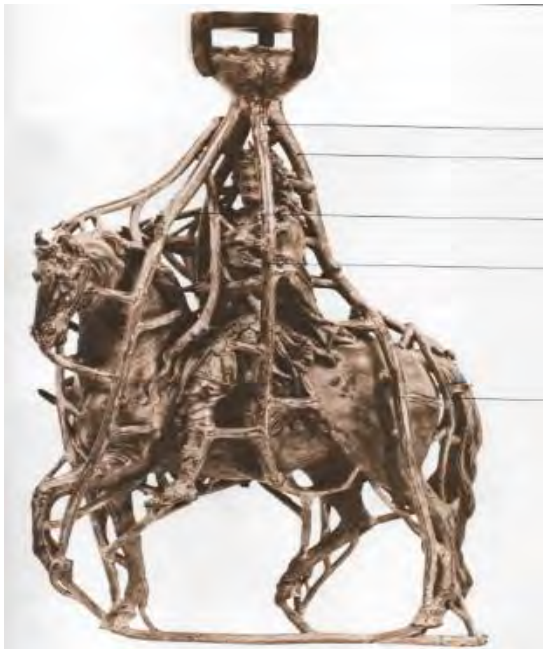
Figure 9 : Bronze (56cm) réalisé selon la technique de cire perdue dont les jets et événements sont restés en place.
