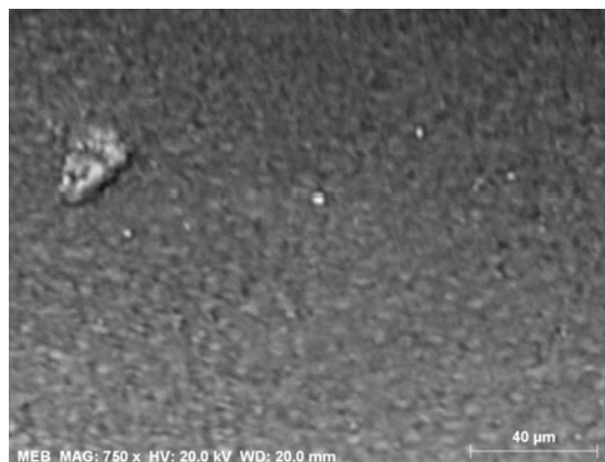
Figure 23 : Smear layer recouvrant complètement les tubulis dentinaires (x750)
