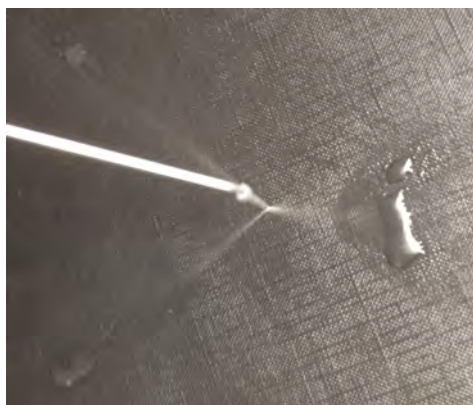
Figure 36 : Illustration des 3 ouvertures latérales, créant 3 jets distincts de produit.
