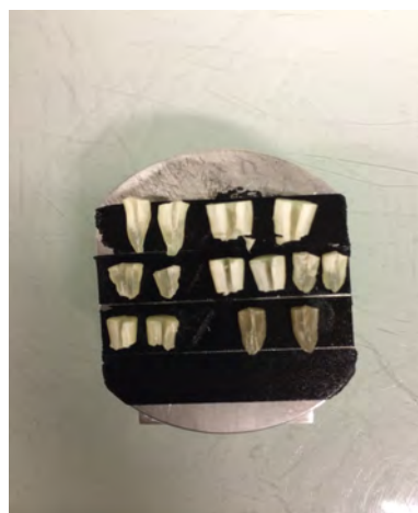
Figure 38 : Groupe 1 séparé en fragment (gauche) et chariot du MEB avec les fragments sur scotch carbone (droite)
