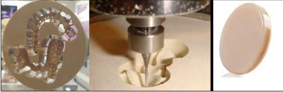
Figure 23 : PEEK usiné (à gauche) et bloc de PMMA (à droite)
