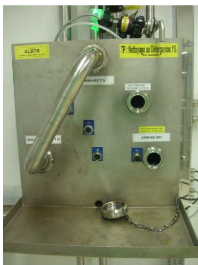
Figure 40 : Exemple de Tableau de pontage incomplet.
