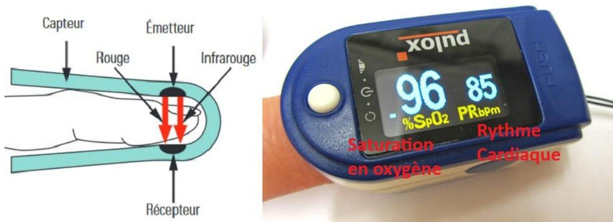
Image 12 : A gauche, fonctionnement d'un oxymètre de pouls et à droite, oxymètre de pouls positionné au niveau d'un index affichant la saturation en oxygène et le rythme cardiaque
