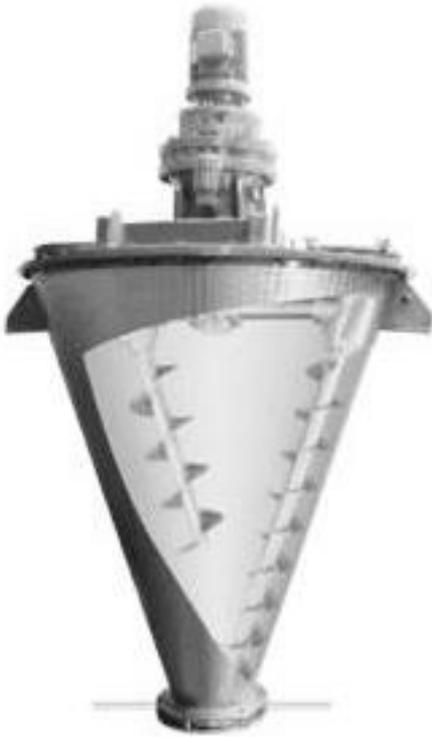
Figure 29 - Mélangeur convectif à vis orbitales
