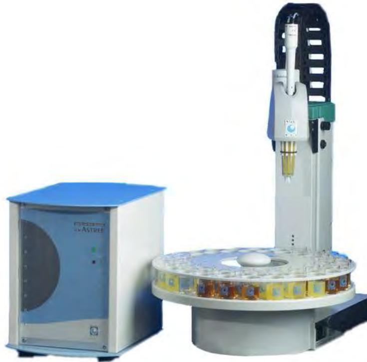
Figure 17 - Langue électronique ASTREE des laboratoires Alpha M.O.S ([www.alpha-mos.com](http://www.alpha-mos.com)) [59]
