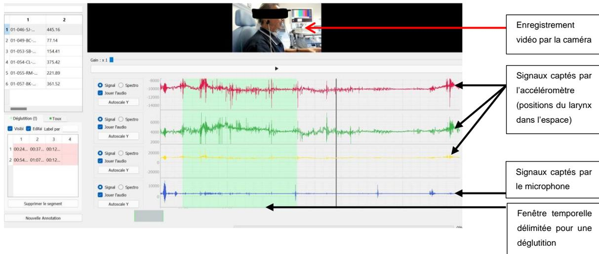
Figure 7 : Capture d'écran du logiciel montrant les données détectées par le dispositif Swallis DSA™
