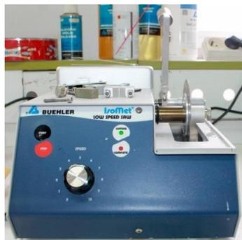
**Photo 2** : Scie diamantée à faible vitesse (IsoMet de Buehler)
