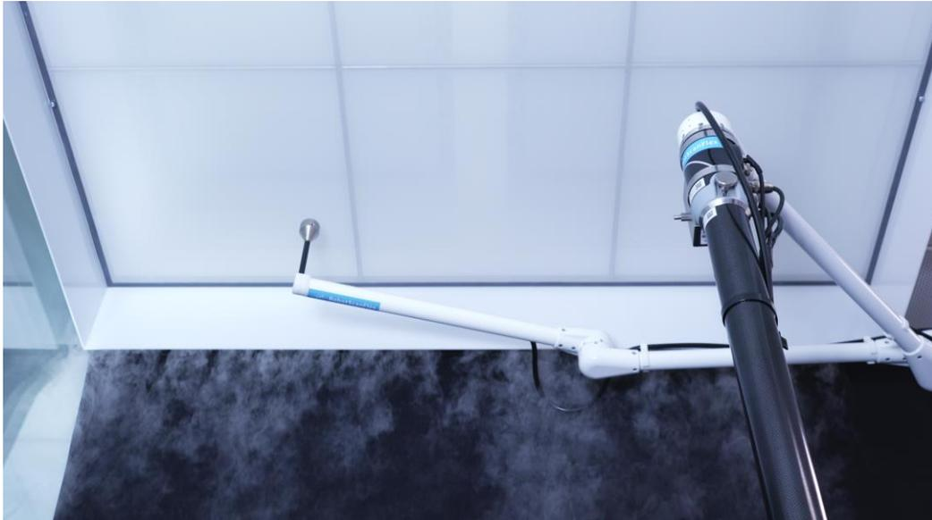
Figure 65 : essais d'intégrité d'un filtre HEPA avec un RobotScanFlex® [62]
