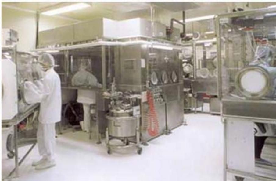
*Figure 30 : Isolateur d'une ligne de remplissage - Circa 1988 [47]*
