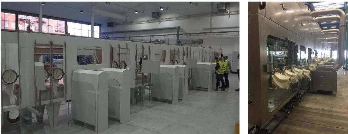
Figure 64 : exemple d'une maquette d'isolateur (à gauche) et du rendu final chez le client (à droite)
