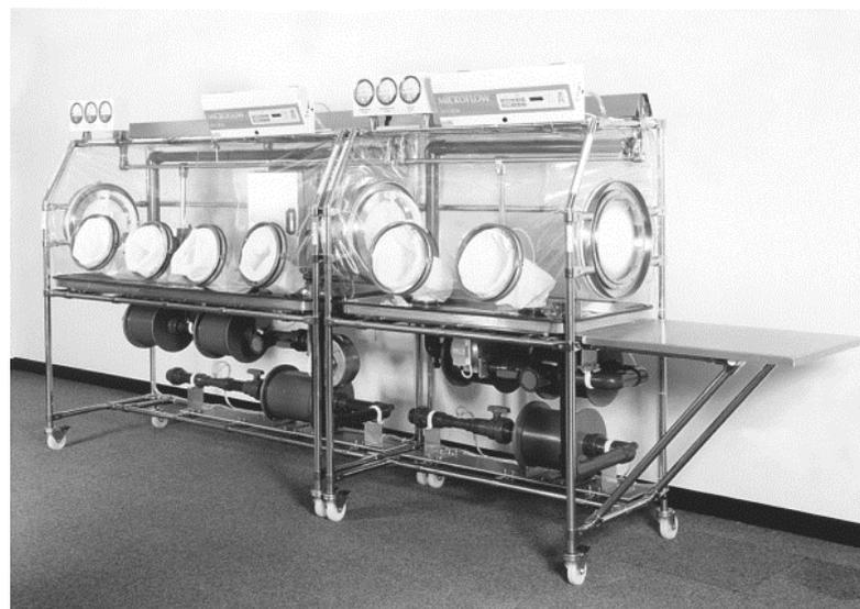
Figure 29 : Un Isolateur à paroi "flexible" utilisé pour des tests de stérilités dans un laboratoire sur des produits sanguins (Courtesy of Astec Microflow.) [45]
