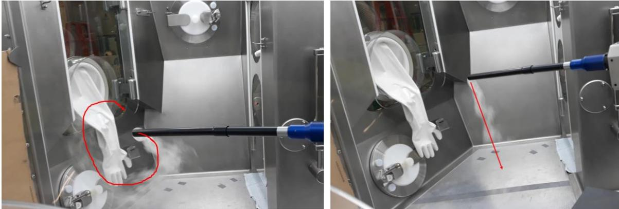
Figure 66 : Tests de fumée mettant en évidence une turbulence (à gauche) et un flux conforme (à droite)
