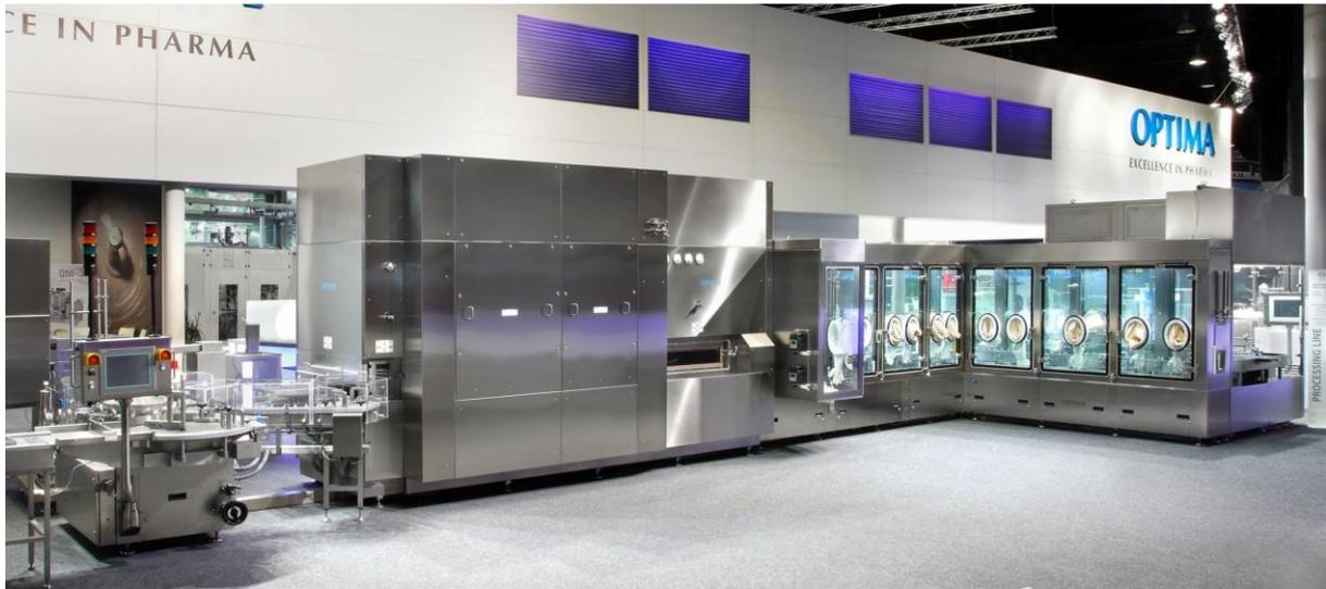
Figure 31 : Ligne complète de répartition aseptique. Lavage des flacons, tunnel et sous isolateur remplissage bouchage lyophilisation (source : Optima)
