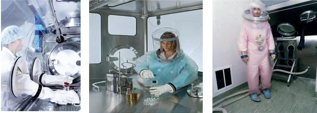
Figure 32 : Différents dispositifs de manipulation gants (gauche), demi-scaphandre (milieu) et combinaison intégrale (droite) [49]
