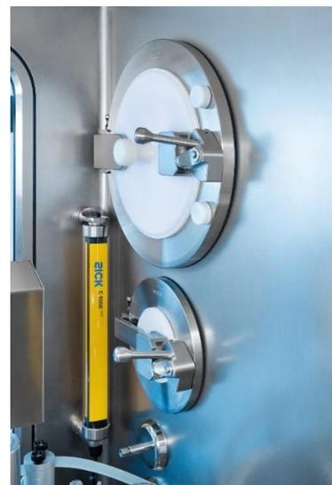
Figure 35 : différents modes d'introduction du matériel mousehole (gauche) et RTP (droite) [51]
