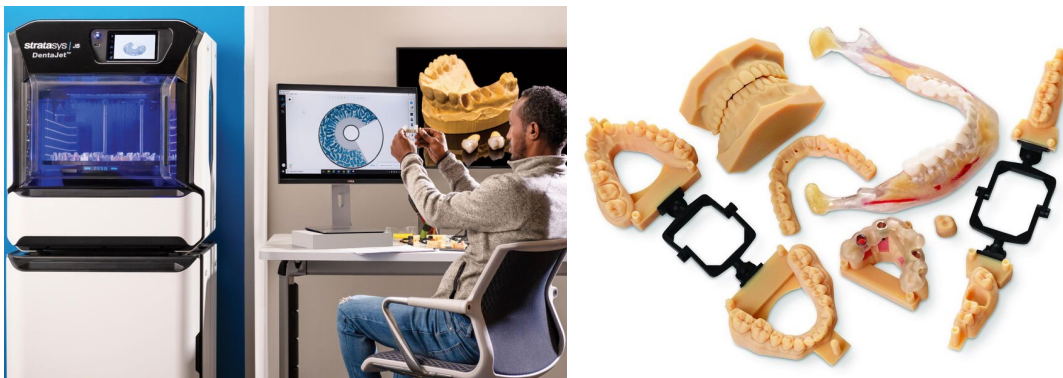
Figure 6 : Imprimante Stratasys à gauche et prothèses et implants dentaires à droite 26 .
