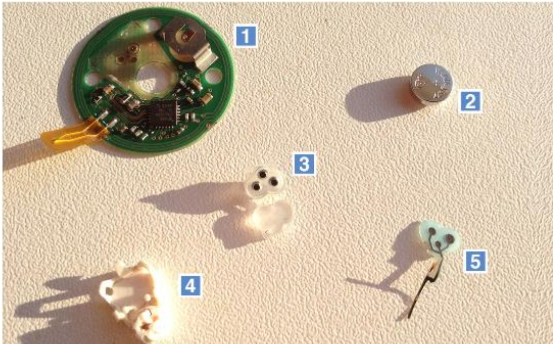
Figure 9 : Photo d'un capteur FreeStyle Libre 2 ® décortiqué [7]
