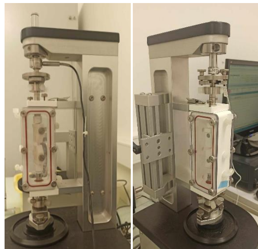
Figure 34 : Photographies de scaffolds lors de tests de traction avec la machine Bose Biodynamic 5100 - BMBI 2024
