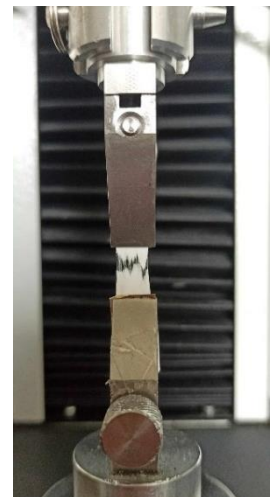
Figure 33 : Photographie d'un scaffold lors d'un test de traction avec la MTS 400 - BMBI 2024
