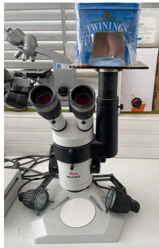
Figure 20 : Stéréo microscope Leica WILD M3B (source : iconographie personnelle, Leica)
