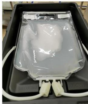
*Figure 8 : Positionnement de la poche à usage unique dans le contenant secondaire*
