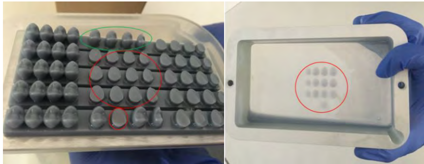
Figure 19 : Décollement des modèles centraux lors de la 3ème impression d'affilée. Figure de gauche : Cercle Vert : modèles imprimés correctement ; Cercle Rouge : Modèles avec échec d'impression. Figure de droite : Bac de résine avec à l'intérieur du cercle rouge les modèles collés au film FEP (Photos Personnelles)
