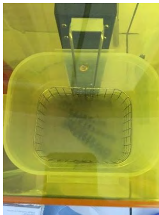
Figure 17 : Rinçage du modèle à l'alcool isopropylique à l'aide de la machine Elegoo® Mercury Plus (Photos Personnelles)
