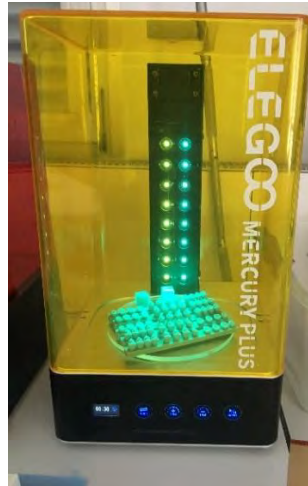
Figure 18 : Polymérisation des modèles de simulation à l'aide de la machine Elegoo ® Mercury Plus (Photos Personnelles)
