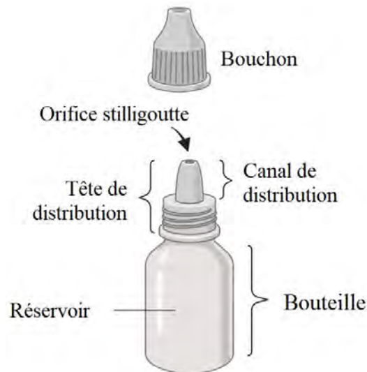
Figure 6 : Description d'un flacon multidose "trois pièces" conventionnel
