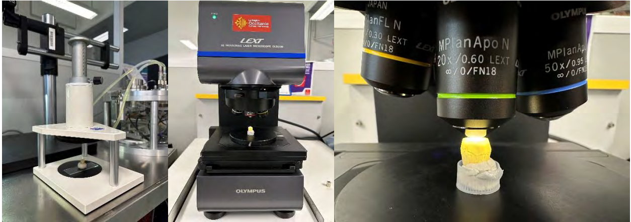
Figure 23 : Photos illustrant le dispositif de presse et d'acquisition permettant d'observer l'altération de l'état de surface causée par les différents traitements de surface.
