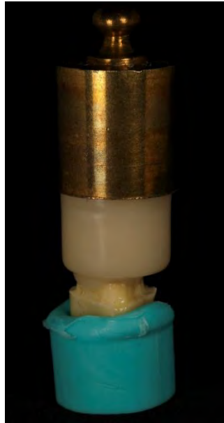
Figure 26 : Photo illustrant la phase d'autopolymérisation du composite de collage à prise duale dans des conditions standardisées sous une pression de 100g (1 Newton). S'en suivra une photopolymérisation pendant 40 par face.
