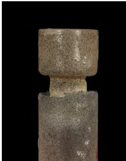
Figure 30 : Photo illustrant la réalisation du mouchetis permettant une reconnaissance spatiale du motif projeté par l'objectif apochromatique afin de réaliser, à posteriori, une analyse de la propagation des fissures à l'aide d'une analyse par corrélation d'images.
