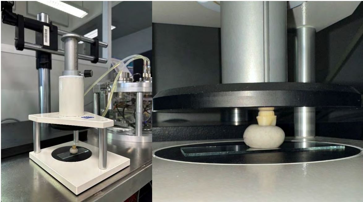
Figure 12 : Photos illustrant le dispositif de presse permettant un parfait parallélisme par rapport au plan d'acquisition de l'aire de collage.
