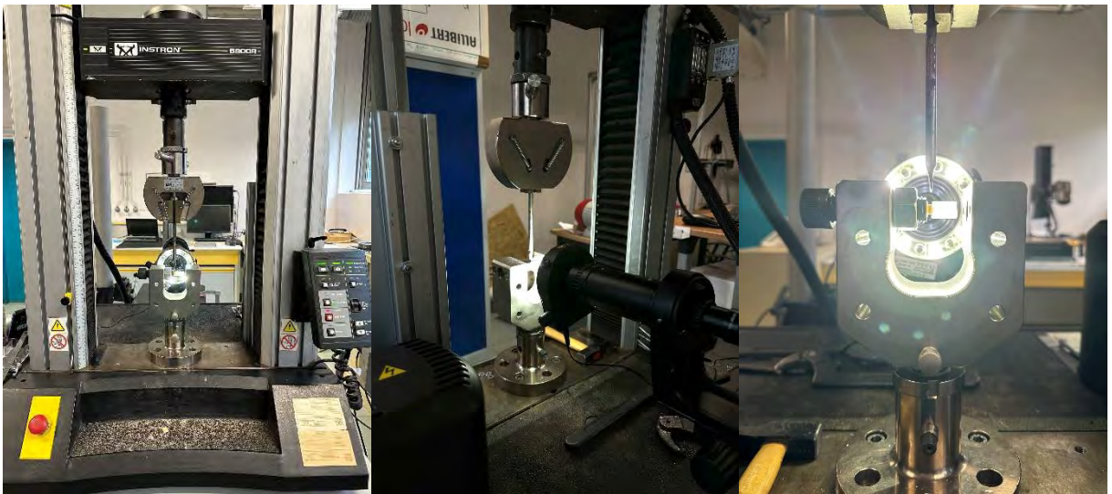
Figure 31 : Photos illustrant le dispositif de réalisation des tests de macro-cisaillement ainsi que de l'acquisition de clichés photographiques permettant une analyse par corrélation d'images afin de visualiser la cinématique de rupture.
