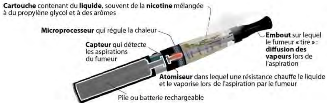
Figure 3 - Composition d'une cigarette électronique (70)
