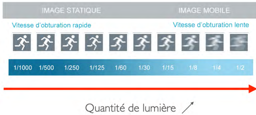
Figure 24 - Évolution de la netteté de l'image et de la quantité de lumière en fonction de la variation de la vitesse d'obturation
