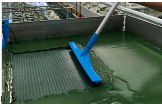
Figure 6 : Filtration de la biomasse (15)
