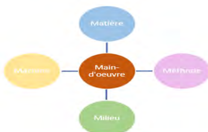
Figure 25 : Schéma des 5M : investigation root cause
