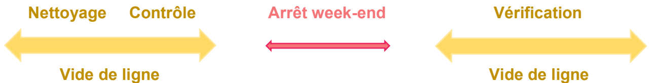
Figure 5 : Schéma de la chronologie d'un vide de ligne lors d'un arrêt week-end
