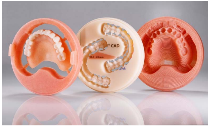
Figure 83 : usinage de la base (disque Ivobase® CAD), de l'arc dentaire (disque DCL SR Vivodent® CAD) et assemblage avec le protocole Ivoclar Vivadent Digital Denture.
