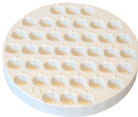
Figure 11 : Socle fabriqué par dépôt de fil fondu avec 40 alvéoles (source : document personnel)
