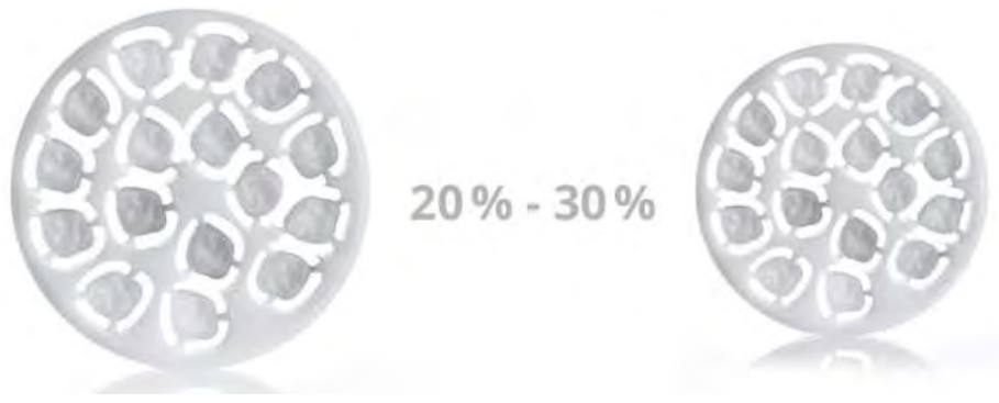
Figure 22 : Contraction en volume avant et après cuisson (18)
