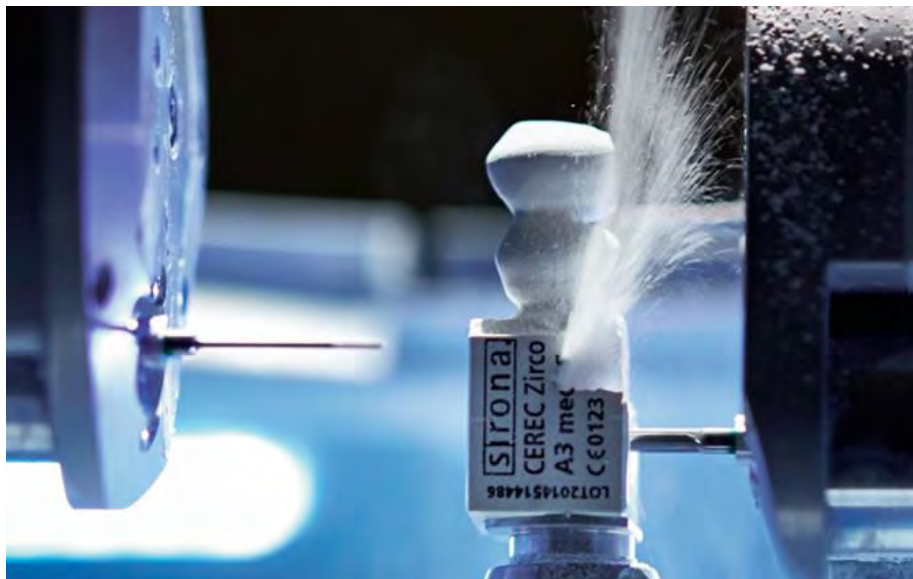
Figure 21 : Usinage de la zircone en milieu sec (18)
