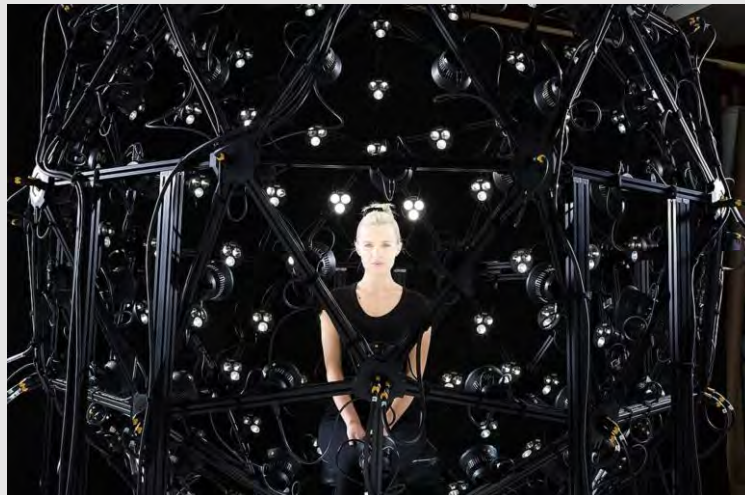
Figure 41 : « The light Stage » permettant de scanner la face d'un acteur ou actrice pour sa doublure numérique
