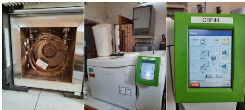
Photographie 43 : Four avec colonne et système de CG avec écran de pilotage au Laboratoire de Contrôle qualité chez l'IMRA - 28/03/2022 -
