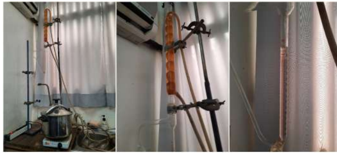
Photographie 35 : Machinerie distillation, réfrigérant et apparition de l'huile essentielle de Ravintsara chez l'IMRA - 28/03/2022 -
