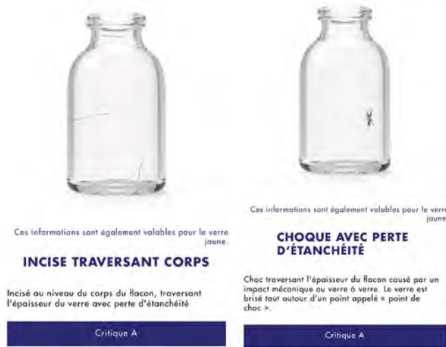
Figure 34 : Exemples de défaut de traversants dans le verre classés par SGD Pharma 24,95
