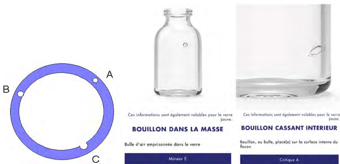
Figure 33 : Exemples de défaut de bouillons dans le verre classés par SGD Pharma 24,95
