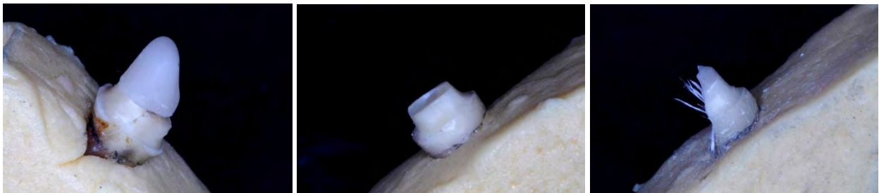
Figure 15 : Rupture dentaire, rupture du matériau et rupture mixte (respectivement de gauche à droite).
