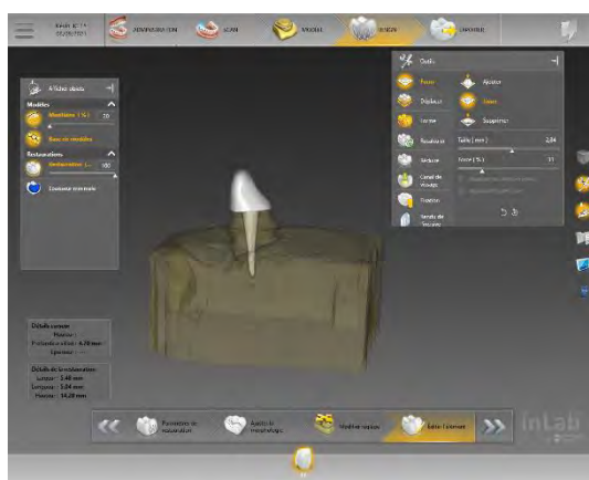
Figure 10 : Conception assistée par ordinateur d'un inlay-core avec le logiciel InLab® 18.1 (Dentsply Sirona).
