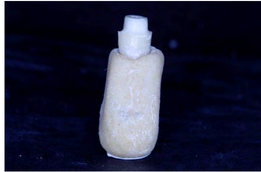
Figure 6 : Soilage de l'échantillon dans de la résine acrylique autopolymérisable (SR Ivolen ® , Ivoclar Vivadent) au sein d'un système permettant une orientation à 45° de la dent.
