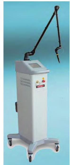
Figure 9 : Bras articulé sur laser CO<sub>2</sub> (64)
