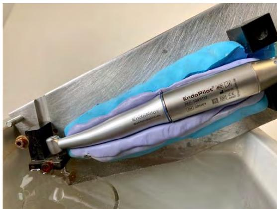
Photo 2 : Moteur Endopilot positionné sur le banc de fatigue
