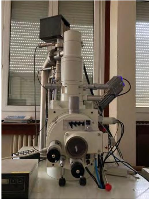
Photo 4 : microscope électronique à balayage
