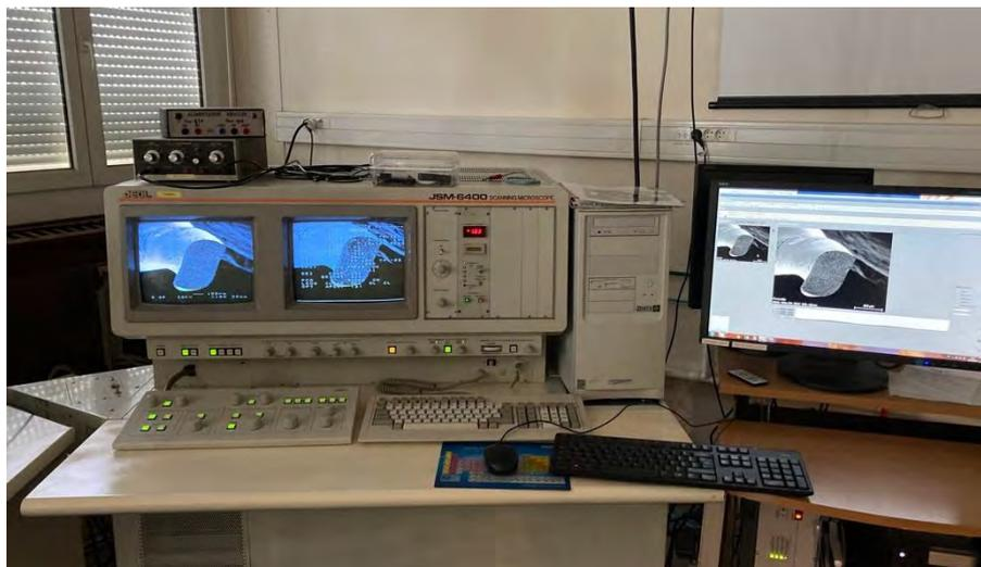
Photo 5 : microscope électronique JSM 6400
