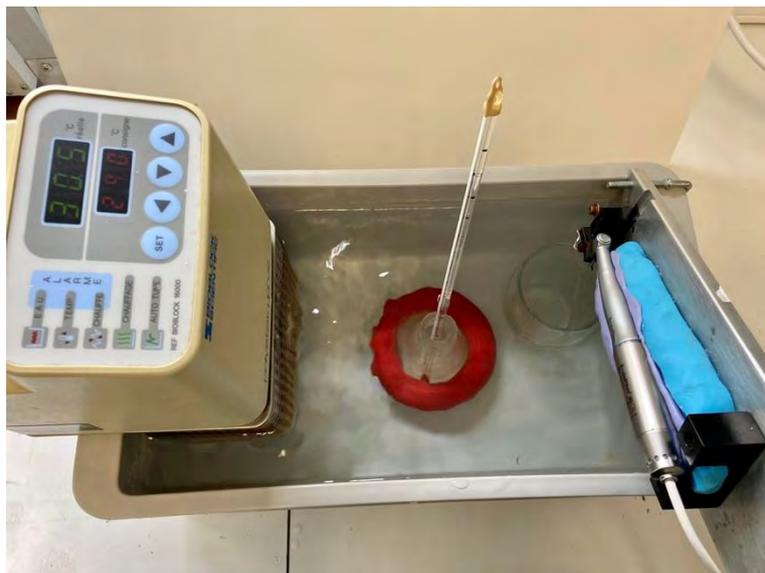
Photo 1 : Banc d'essai simulant l'environnement ambiant et oral
