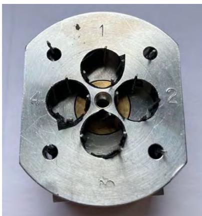
Photo 3 : instruments pré-coupés placés sur un support métallique
