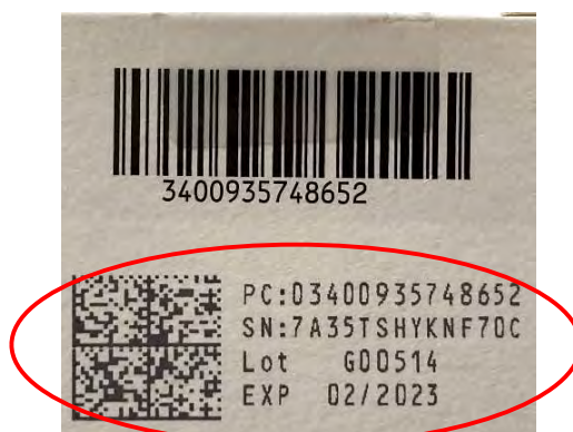
Figure 5 : Datamatrix + informations en clair : GTIN ; n° de série ; n° de lot ; date de péremption (Source Interne Site de Distribution)
