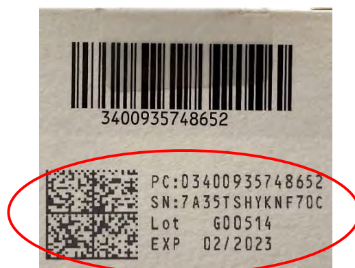
Figure 11 : Datamatrix + informations en clair : GTIN ; n° de série ; n° de lot ; date de péremption (Source Interne Site de Distribution)
