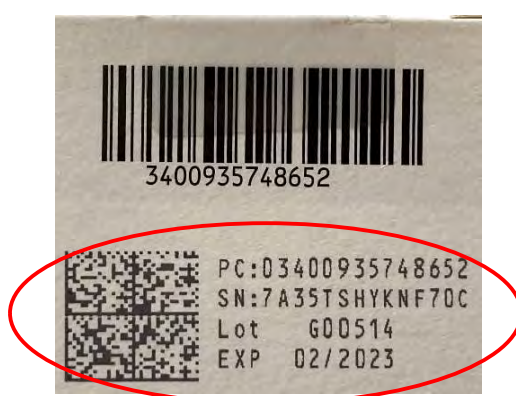
Figure 17 : Datamatrix + informations en clair : GTIN ; n° de série ; n° de lot ; date de péremption (Source Interne Site de Distribution)
