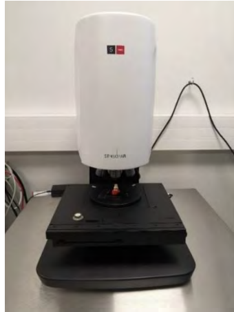
Figure 4 : Profilomètre S-Neox®, (Sensoflar, Espagne) au Laboratoire CIRIMAT à Toulouse
