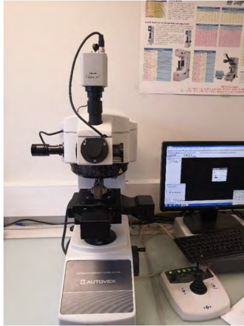
Figure 10 : microduromètre HM-200(Mitutoyo, Japon) au Laboratoire CIRIMAT à Toulouse
