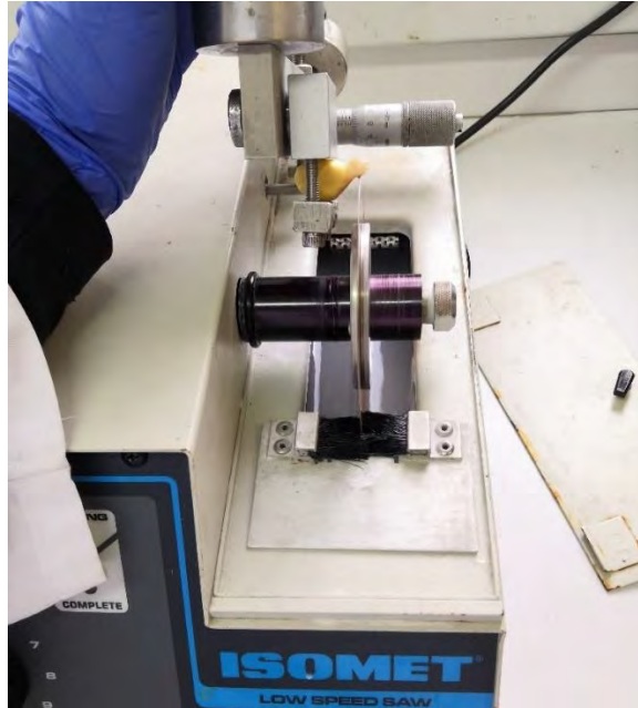
Figure 1 : Découpe des échantillons de dents à la disqueuse (Faculté de Chirurgie Dentaire, Toulouse)
