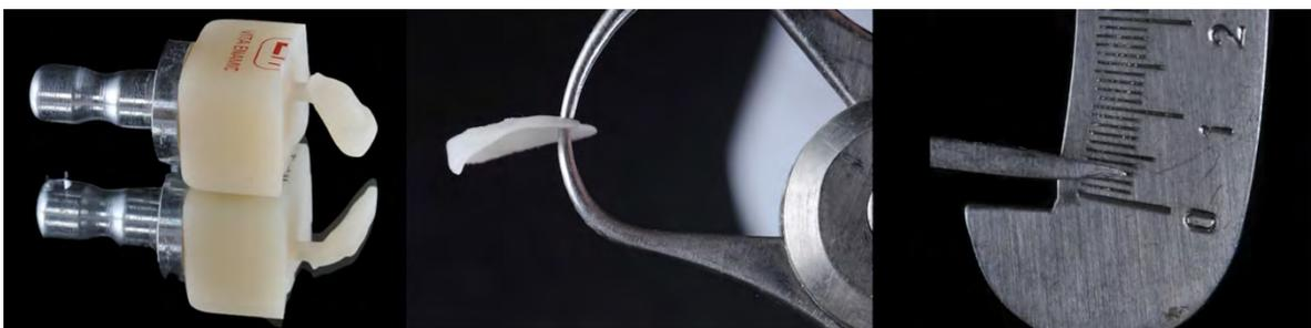
*Fig. 32 : Table top d'une épaisseur de 0,2mm usiné en CFAO à partir d'un bloc de VITA ENAMIC (108).*
