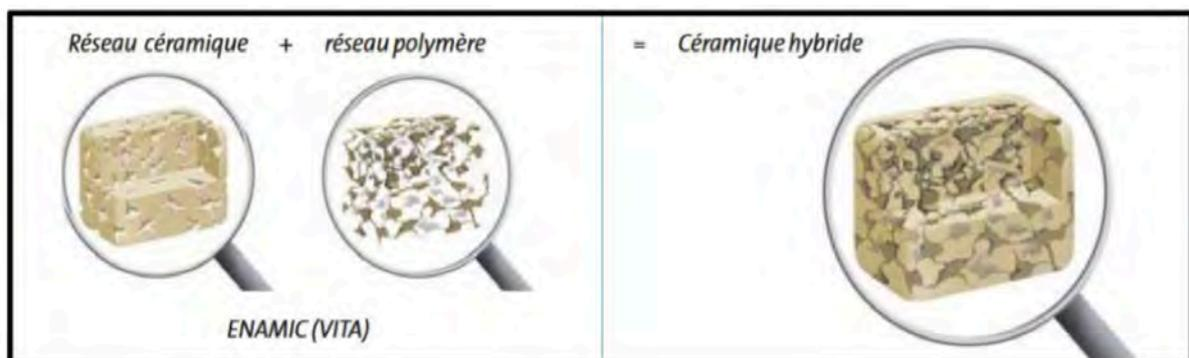
Fig 22 : Schéma d'une céramique hybride type ENAMIC Vita d'après DUTEL 2015 (61).
