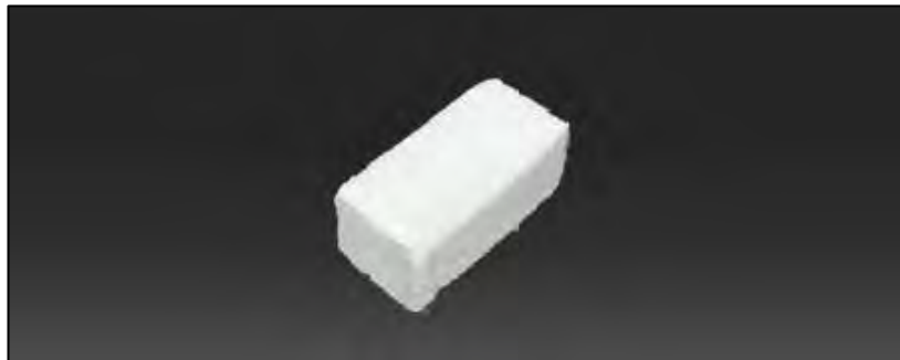
Figure 10 : Blocs de substitut osseux redimensionnés 15,4x19x39 mm.
