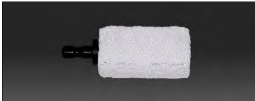
Figure 11 : Bloc de substitut osseux redimensionné et fixé au support pour usineuse de CFAO.
