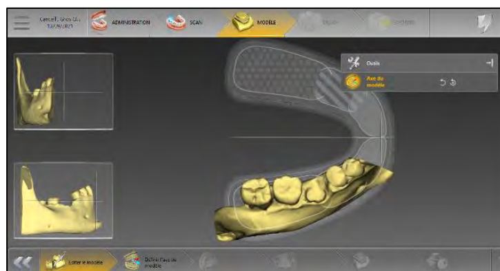
Figure 13 : Segmentation de la mandibule et positionnement du fichier sur la ligne d'arcade.
