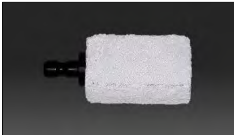
Figure 7 : Bloc de substitut osseux redimensionné et fixé au support pour usineuse de CFAO.
