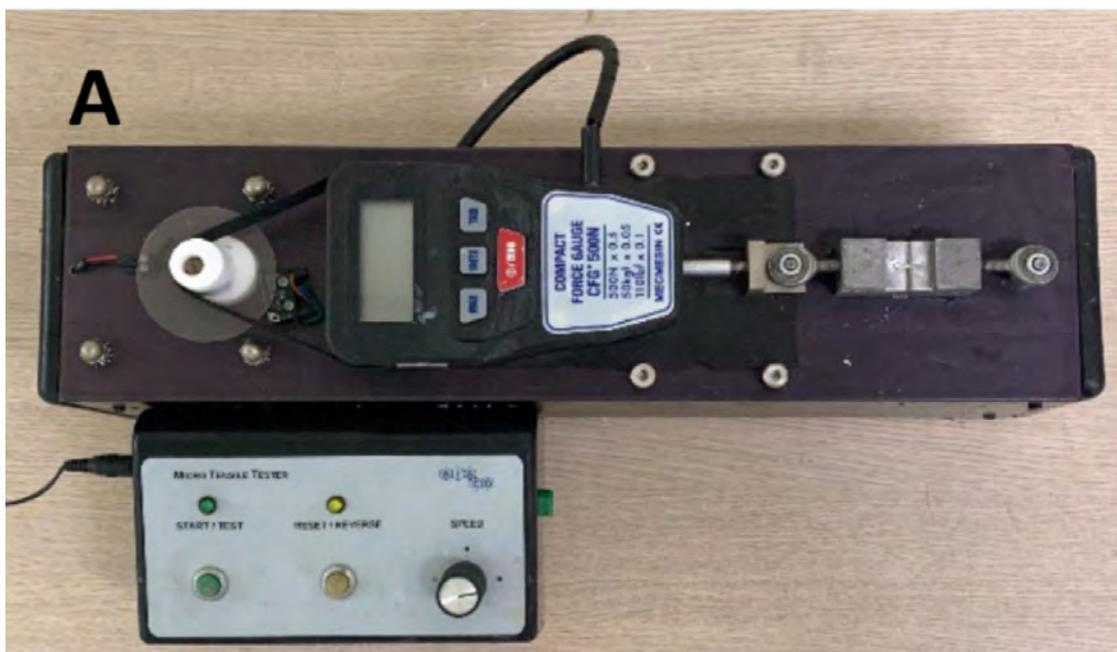
(Figure 27 : Machine permettant de réaliser le test de traction)
