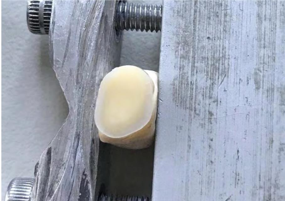
*(Figure 26 : Surface dentaire après découpe au disque basse vitesse)*
