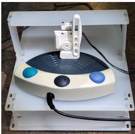
**Fig. 38** : Positionnement d'une pédale à activation verticale sur l'actionneur
