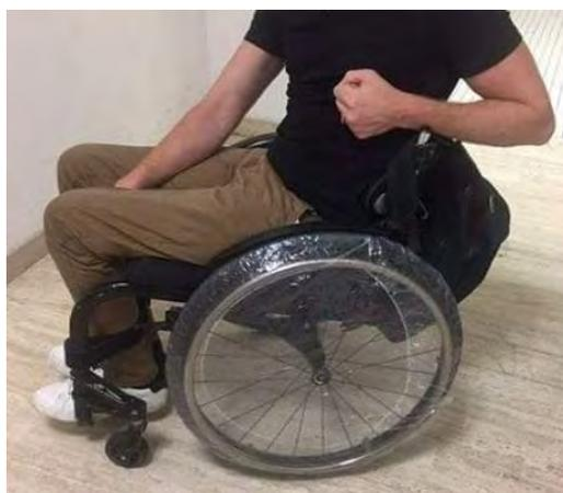
**Fig. 9 :** Protection pour scialytique de bloc disposée sur la roue du fauteuil roulant
