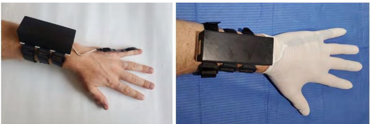
**Fig. 33** : Capteur installé, boîtier fermé, avant et après avoir mis le gant
