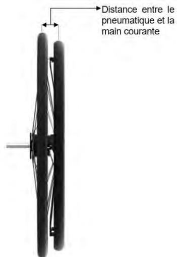
**Fig. 10** : Vue frontale de la roue arrière du fauteuil roulant
