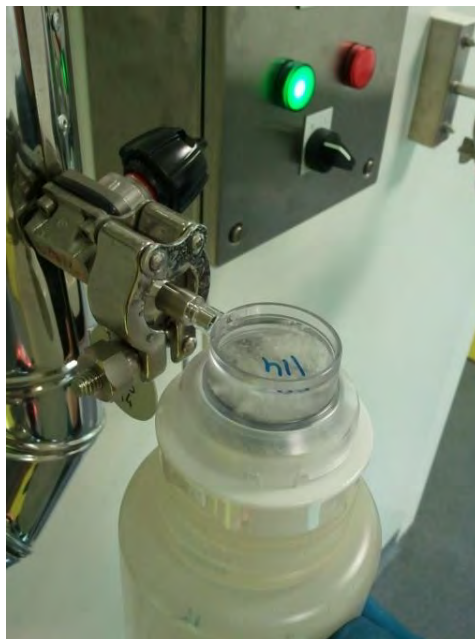
Figure 24 - Prélèvement bactériologique au niveau d'un point d'échantillonnage stérile avec un dispositif MicropreSure®
