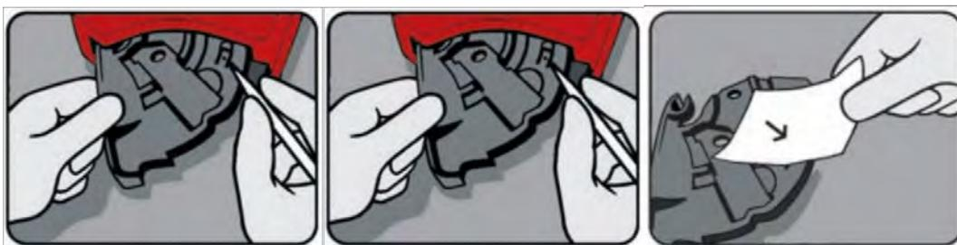
Lorsque la cellule optique est sale (indiqué par un message d'erreur, voir point suivant) :
