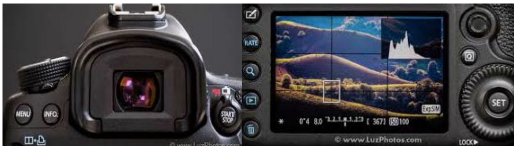
Figure 43: Appareil photo à visée réflex et à visée par l'écran
