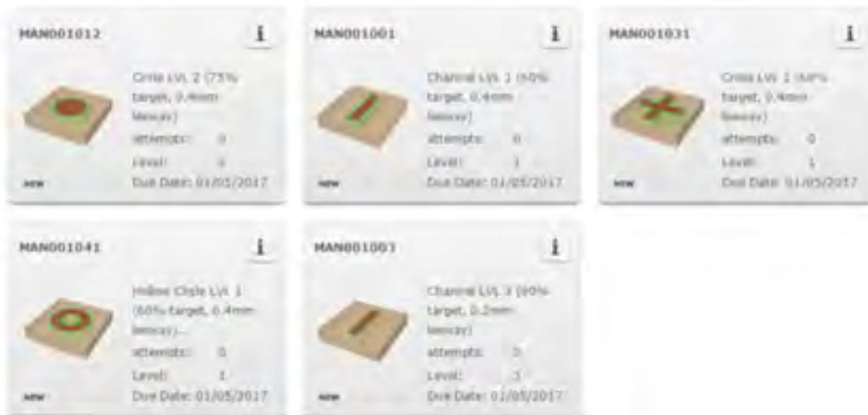
Figure 2 : Exercices simples d'acquisition de la dextérité qui consistent à fraiser les parties foncées et à garder intactes les parties vertes.
