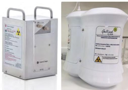
**Figure 8** : Générateur  $^{68}\text{Ge}/^{68}\text{Ga}$  (GalliaPharm® à gauche et IRE® Galli Ad à droite)
