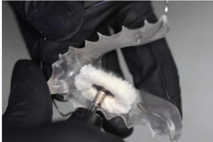
*Figure 20* : Polissage de la résine acrylique à l'aide d'une pièce à main et d'une fraise résine (73)
